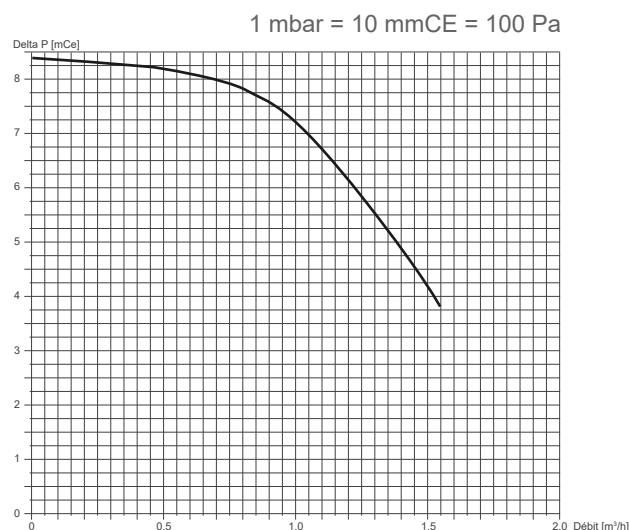
fig. 2 - Beschikbare hydraulische druk- en debietwaarden
